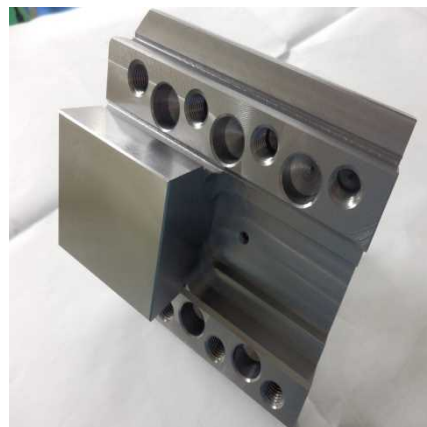
千分台の幾何公差を実現した多面加工品
