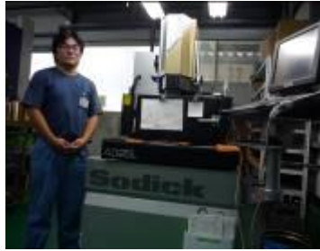
ソディック社製 放電加工機 超硬回路+リニア搭載
