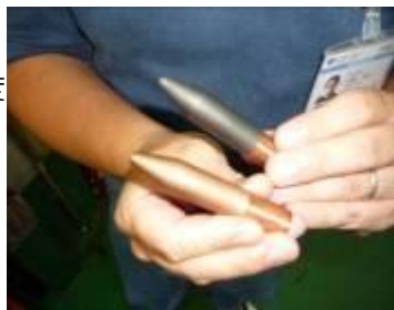
自社加工による電極部(材質:銅)
