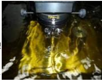
電極(写真中央)と放電加工液 <ワークは液中>
