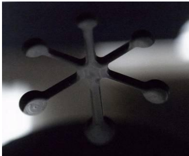
SiC セラミックスへの 0.5mm 溝加工
