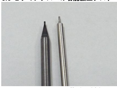
これまで用いていた電着砥石(右)と、加工に成功したエンドミル(左)。加工時間、工具取替え頻度を共に1/2にすることができました。
