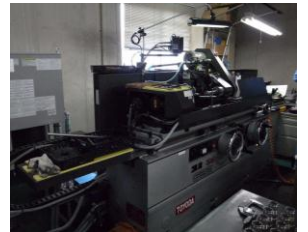
超硬を溶射したワーク(上)と、円筒研磨機(下)
