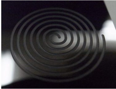
SiC セラミックスへの切削加工テスト
