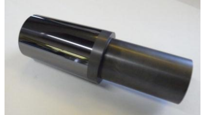
SiC セラミックスのヘリカル切削加工(左)と鏡面加工(右)
